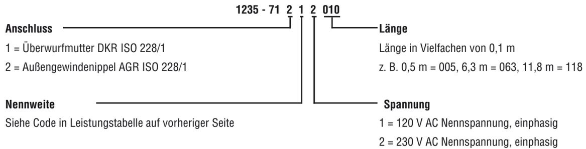
**Beispiel:** 1 m Heizschlauch, 4 mm Nennweite, 230 V Versorgungsspannung, AGR-Anschluss
